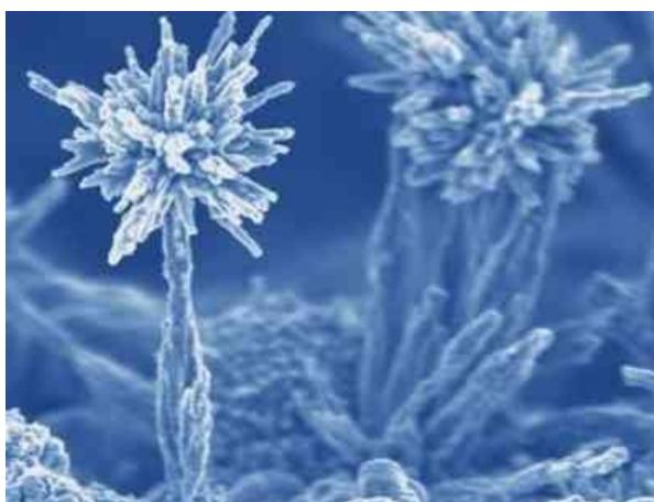
نانودرختی که از نانوسیم‌های کریید سیلیکون ساخته شده است
